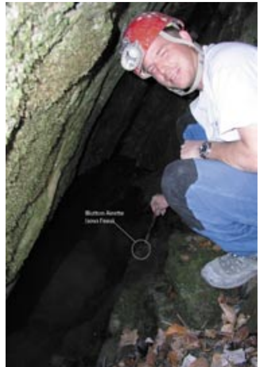
Fig. 2.4: Situation du IButton du bas au siphon de l'Airette. En période de crue le IButton est noyé et la température baisse subitement. Il est ainsi possible d'observer les crues de manière indirecte. >>>
